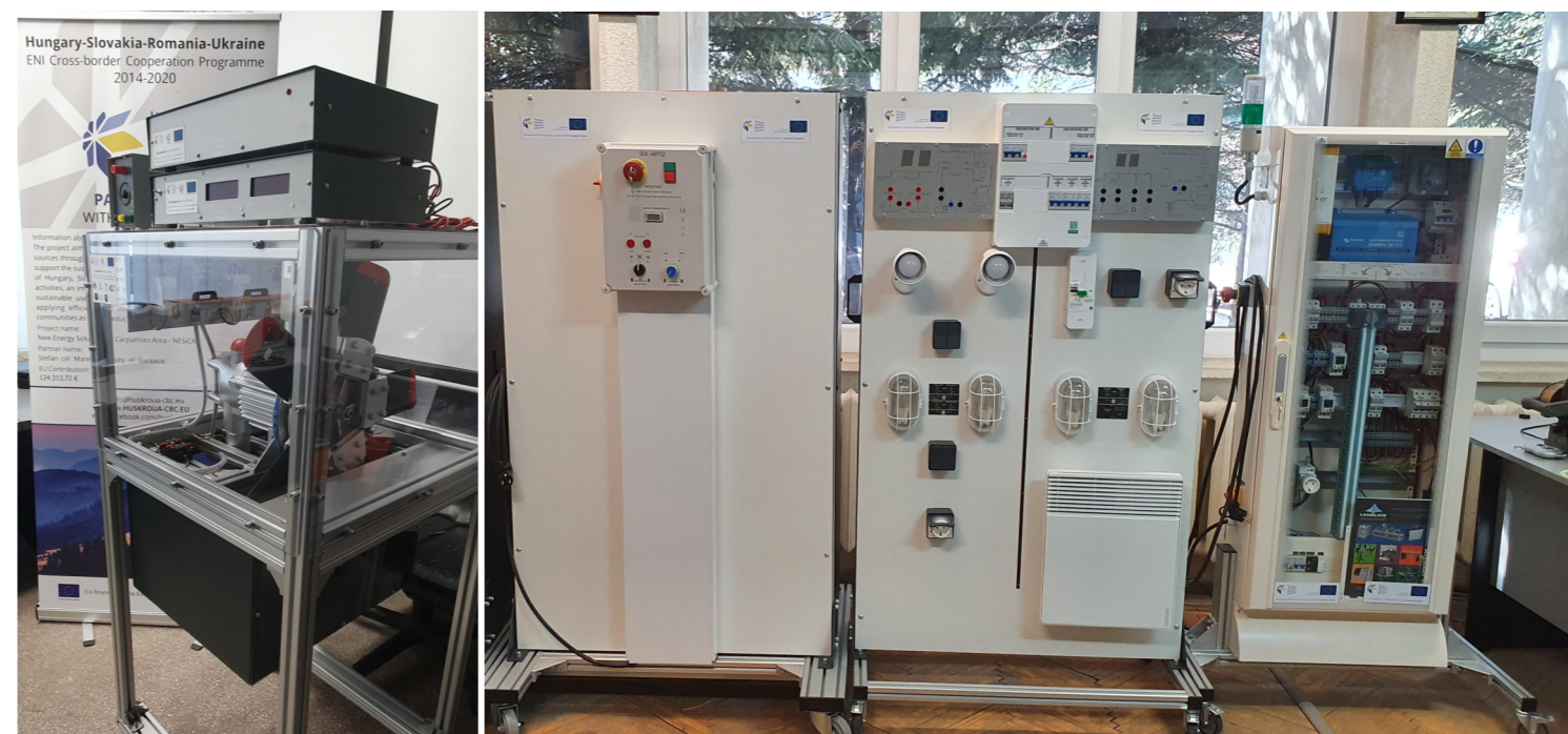
Equipments for the study of the operation of photovoltaic and wind systems. Echipamente pentru studiul funcționării sistemelor fotovoltaice și eoliene.
