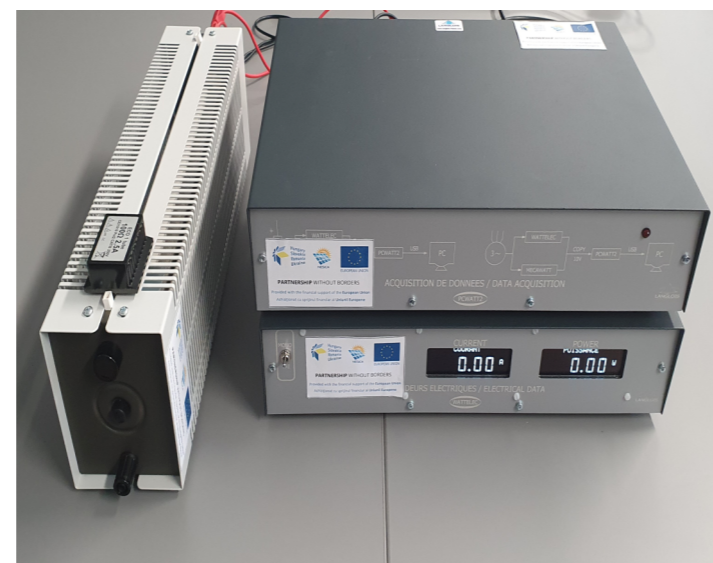
Acquisition pack for wind simulator - EOL-COM2 Sistem de achiziții date pentru simulator eolian - EOL-COM2
