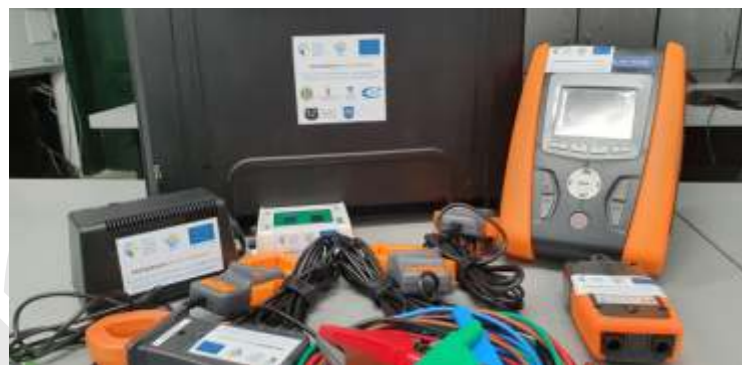
Energy quality analyzer - Solar 300N Analizor de calitate a energiei - Solar 300N
