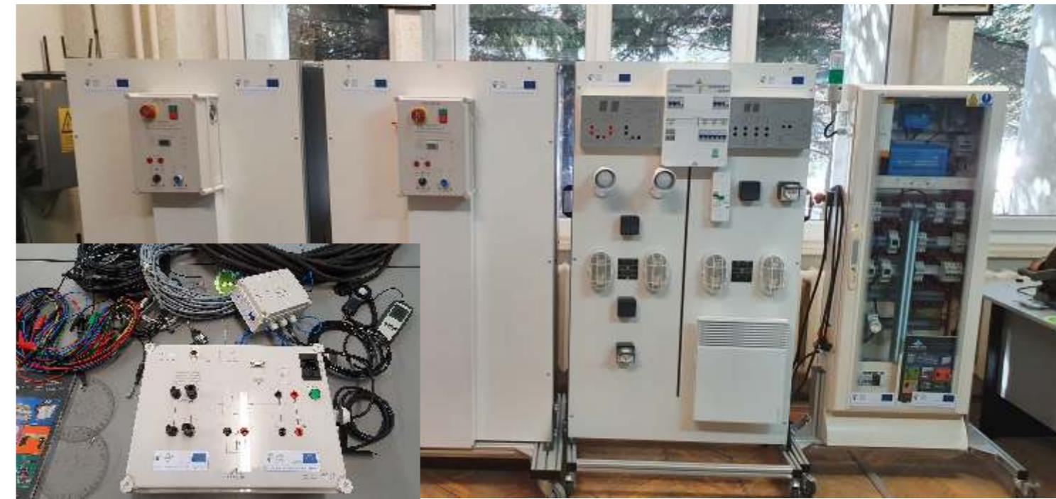
Stand for the study of the operation of on-grid and off-grid photovoltaic systems. Stand pentru studiul funcționării sistemelor fotovoltaice on-grid și off-grid.
